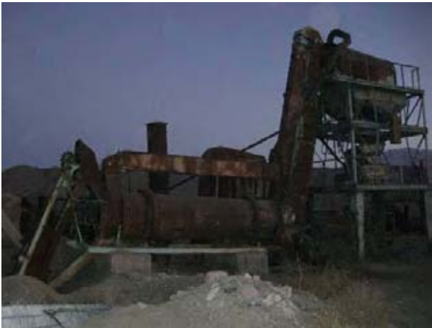
Kochkor-Arai-Tjuya-Ashuu (EM16) Jungal 近く。ソ連時代に設置されたアスファルトプラント。老朽化が激しく稼働不可の状態
