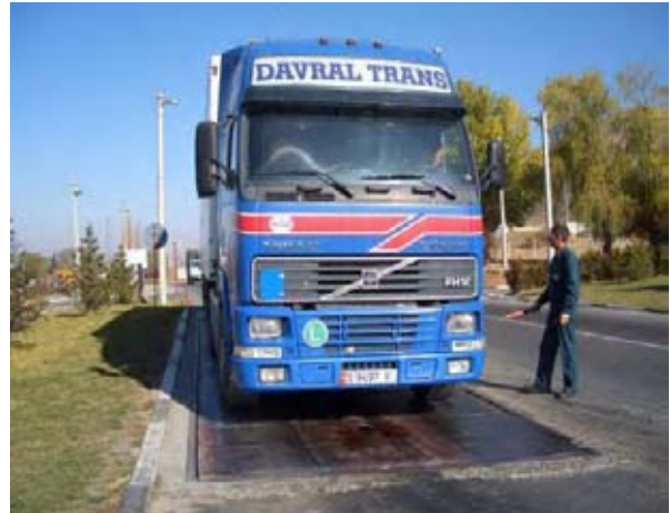
Bishkek-Osh (EM02) Kara Balta 料金所。車両の過積載の取り締まりを行っている。過積載が確認された場合、運転手よりエクセス料金を徴収、徴収後の車両は通行を許可
