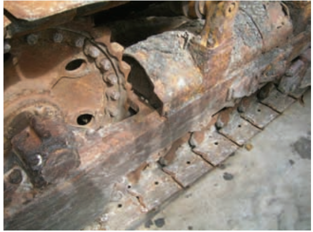
シェファ州事務所所属のコマツ製ブルドーザー、台枠に亀裂が入り修理は非常に困難
