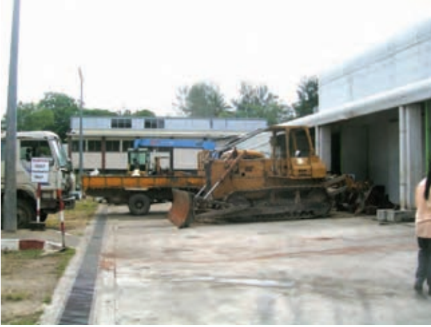
シェファ州事務所所属のコマツ製ブルドーザー、台枠に亀裂が入り修理は非常に困難
