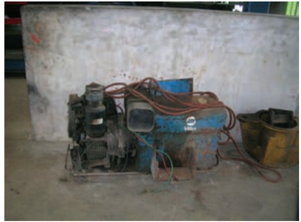
修理不能となっている溶接機
