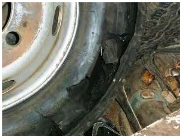
破裂したタイヤ側面
