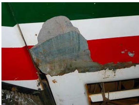
5．無償資金協力による車両。ボディー材質はアルミ材質のため錆が少ない。
