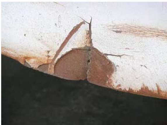
3．2007年調達車両。車両ボディー品質が鉄材のため錆付きが早い。
