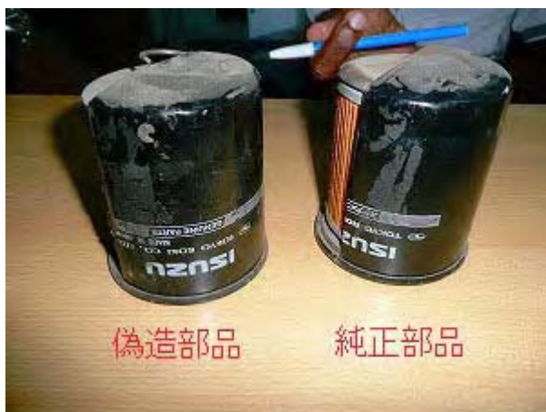
偽造交換部品および純正部品の外観
