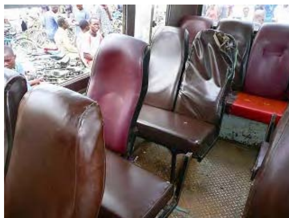
6．稼働している車両も座席破損が多い。乗客が大きな荷物を抱えているため破損頻度が多い。
