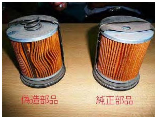
偽造交換部品および純正部品の内部
