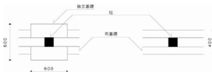
Figure 2-3 Modification de la forme de la fondation
