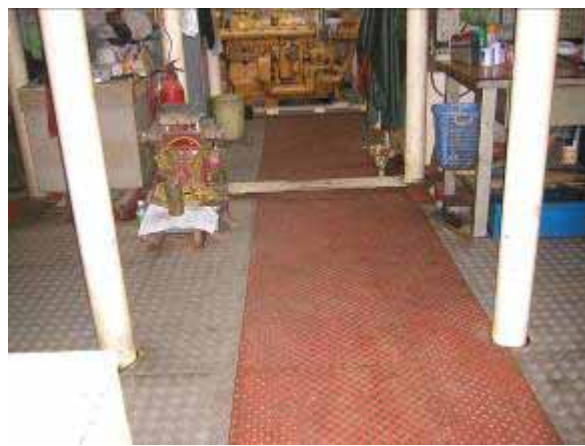
写真-4.3.3 機関室床のグレーチング(右) 機関室の床は油などが飛散し滑りやすくなるため、凹凸がある縞鋼板等のグレーチングを敷くが、清掃が大変である。写真で見ると油で汚れていないと言うことは、グリスや潤滑油の扱いが丁寧である事や、絶えず清掃をしていることが判る。
