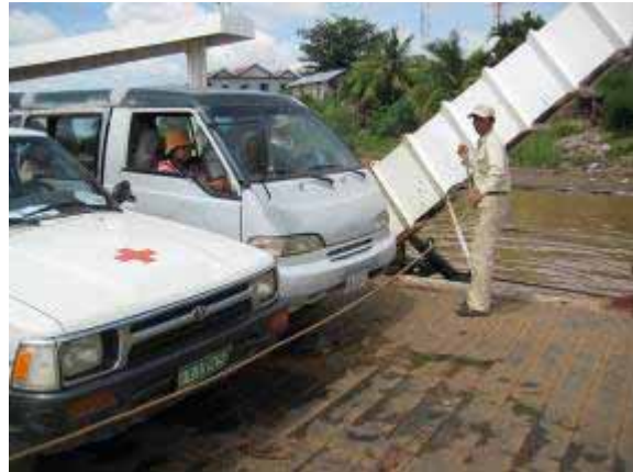
写真-4.7.1 ロープによる車両停止位置表示
