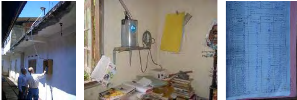
図IV-10 設置された簡易雨量計と住民による雨量の記録
