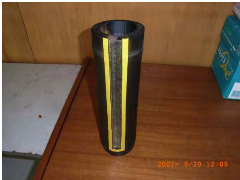
Gambar 6.2.16 Alat ukur curah hujan buatan sendiri dari bambu
