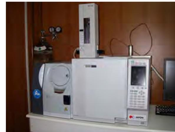
ガスクロマトグラフ/質量分析装置 (GC/MS with P&T)
