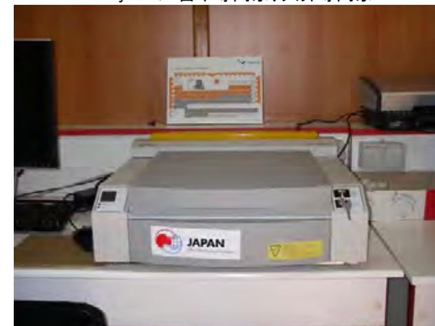
エネルギー分散型蛍光 X 線測定装置 (ED-XRF)
