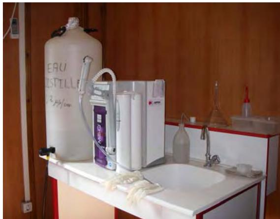
超純水製造装置 (Ultrapure Water System)
