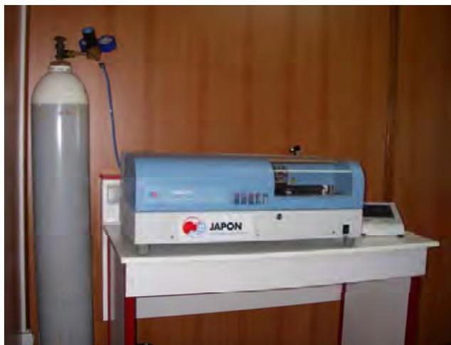
水銀分析計 (Mercury Analyzer)
