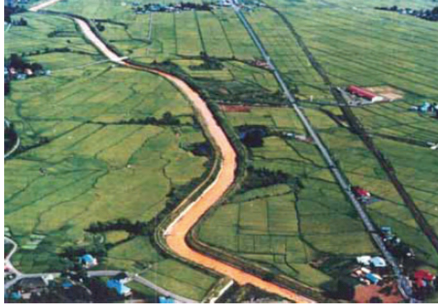
図-42 坑廃水処理前の旧松尾鉱山下流の河川（赤川）の状態
