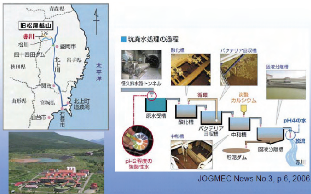
図-46 旧松尾鉱山の坑廃水処理 (鉄酸化バクテリア利用プロセス)
