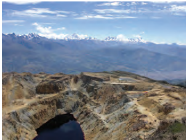
Santa Toribio 鉱山の酸性坑廃水貯留池（手前）と Cordillela Blanca（遠方）
