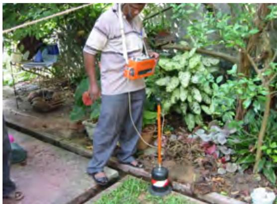
音聴式漏水探知器を使って家庭敷地内の漏水探査をしているところ（有料で実施）。
