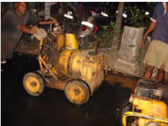
スクレーパー（回転ブラシ）に回転を与えるエンジン式動力機。NWSDBで1台だけ保有。
