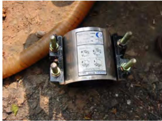
鑄鉄管の亀裂部に巻き止水する管補修用クランプ（英国製）。
