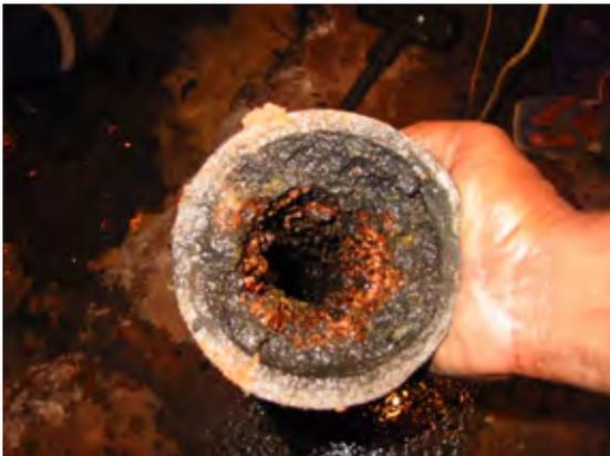
スケールが管断面の70～80%付着しており、流下能力不足と水圧低下をきたしている。このまま放置すると全断面閉塞の危険性もある。
