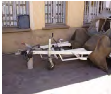
路面の凹凸を計測するプロファイルロメーター
