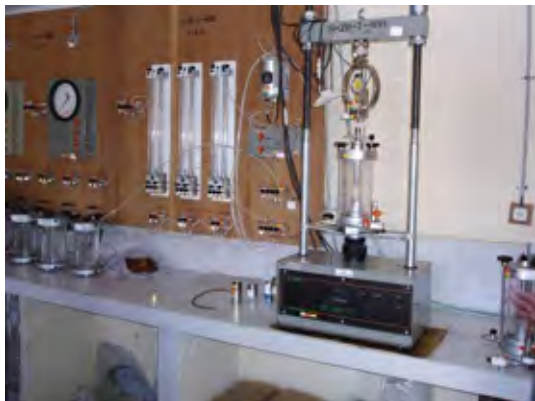
23. ABC 材料試験室の3軸圧縮試験機
