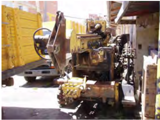
21. ABC の調査用水平ボーリング機
