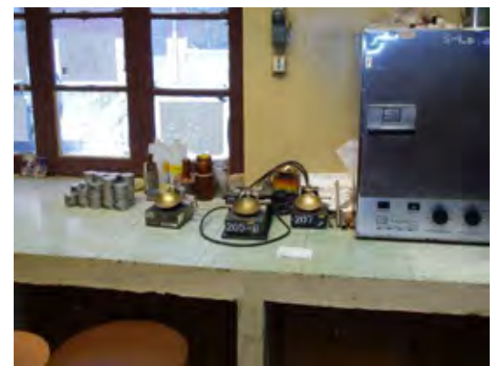
24. ABC 材料試験室の液性限界試験測定器
