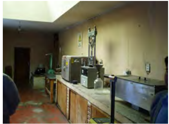
22. ABC 材料試験室のマーシャル安定度試験機
