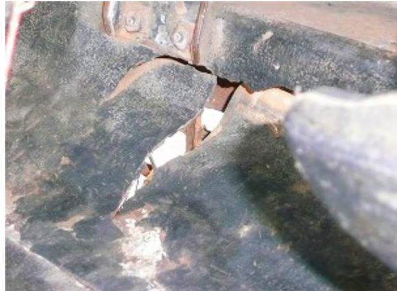
4. 2005年調達車両の運転席床板にひび割れ。脆弱部分に補強策が必要と指摘あり。
