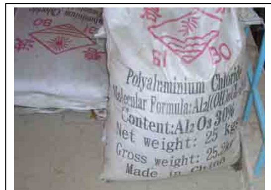
PAC 30% Al 2 O 3 Nhà máy xử lý nước Xuan Phong tại Khanh Hoa
