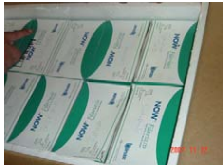
＜サモア国保健省＞ICTの輸送梱包状態。回りを発砲スチロールによる断熱を施して輸送している。
