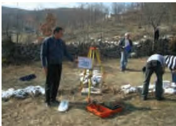
写真 4 : 標定点測量と対空標識設置
