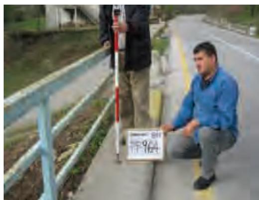
写真 2：水準点を利用した点検測量
