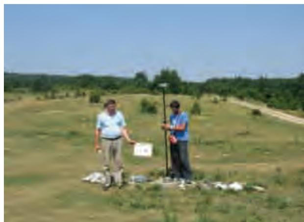
写真 15 : RTK GPS にて既設基準点の検測
