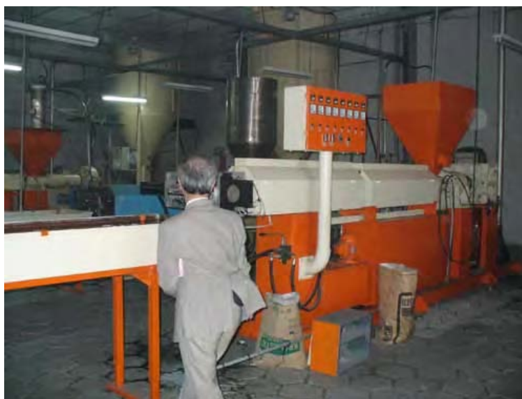
図4 - 8 プラスチックリサイクルNFM社のペレット製造設備
