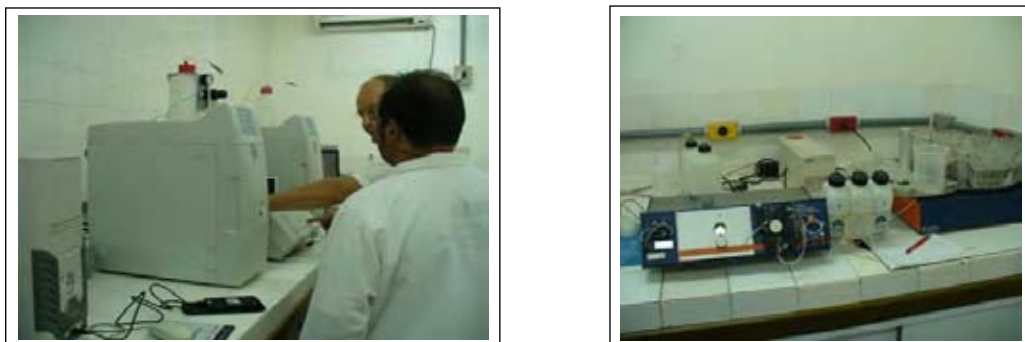
図 4 - 13 INPAの分析機材（左はイオンクロマト、右はFIA）
