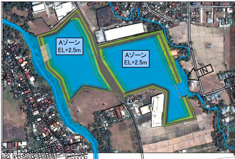
中規模／大規模洪水時、 (2年確率以上の洪水規模時) 遊水地内の全域が浸水の水位が上昇する。
