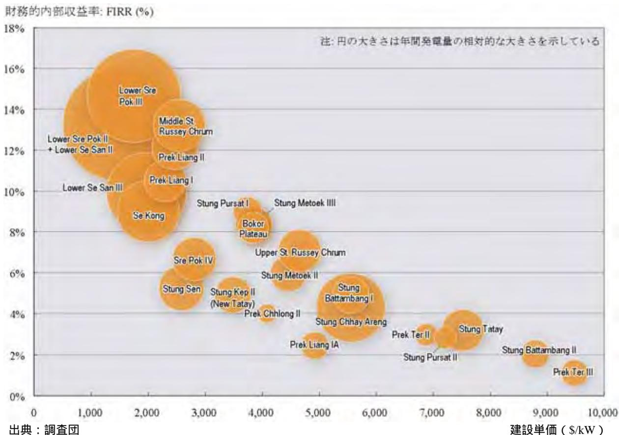
図 4.9.3 候補水力プロジェクトの FIRR, kW あたり建設単価, 年間発電量の関係
