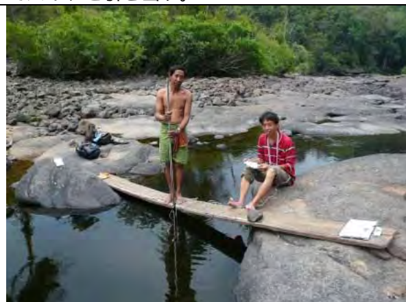
Russey Chrum 川における MIME カウンタパートスタッフによる流量観測風景
