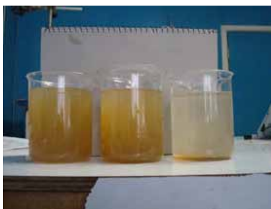
写真－2 沈降試験および凝集沈殿試験の様子（コンビト湧水）
