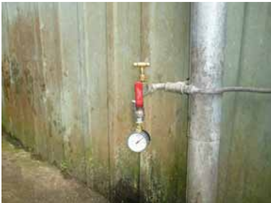
給水圧測定の様子(ブラ地区)。ブラ地区は、配水池から遠いため、水需要の多い日中は、毎日水がない。
