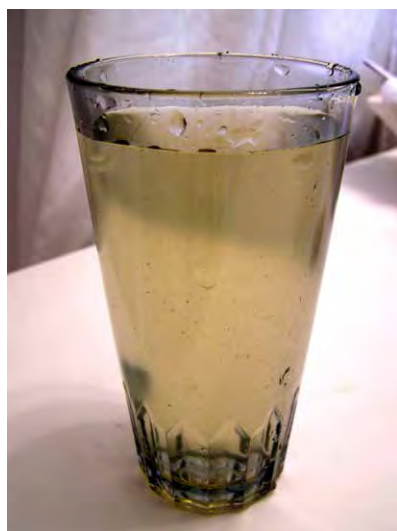
鉄分による赤く着色した水道水。
