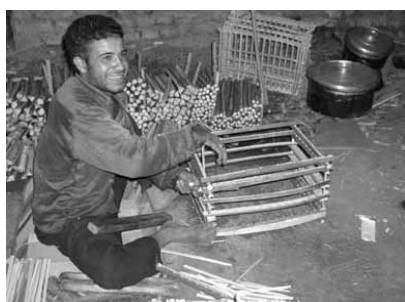
ナツメヤシの葉を利用したカファス製造。伝統的な製法で釘を使わない
