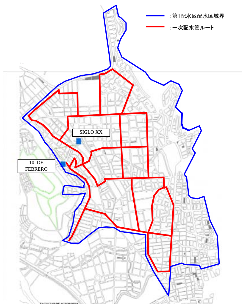
図 3.3 第 1 配水区一次配水管
