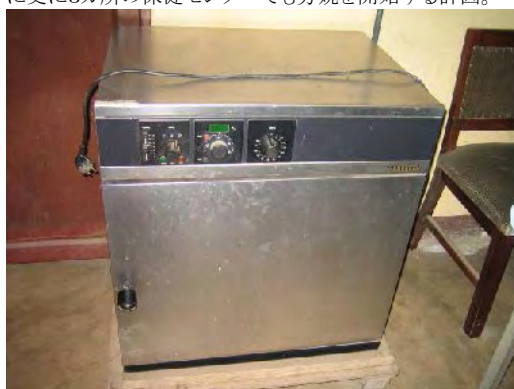
保健センターでは外科処置器具の滅菌に乾熱滅菌器を使っている。電気のない保健センターでは、煮沸消毒もしくは他の保健センターに滅菌を依頼している。
