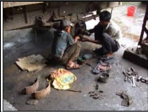
ガレージでの収集車両整備・修理状況 (DCC Workshop-1にて) (十分な整備機材・設備のない場所での作業)
