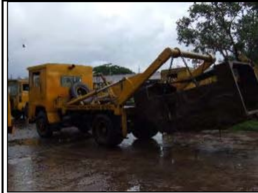
3tコンテナキャリア コンテナ揚上 (DCC Workshop-1にて) (修理して使用し続けている)
