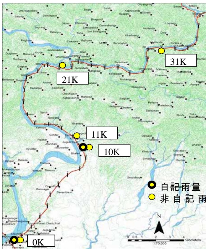
図 5.2.2 雨量計の設置位置
