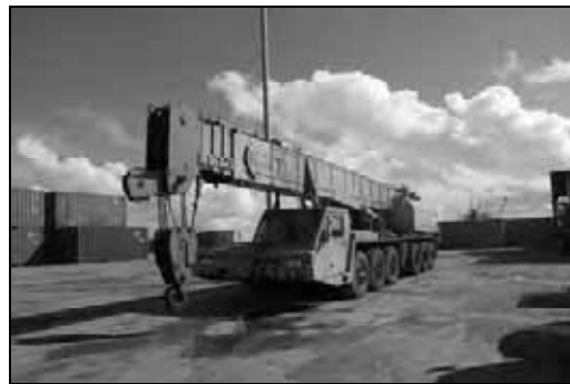
写真-15 80 トン吊りクレーン
