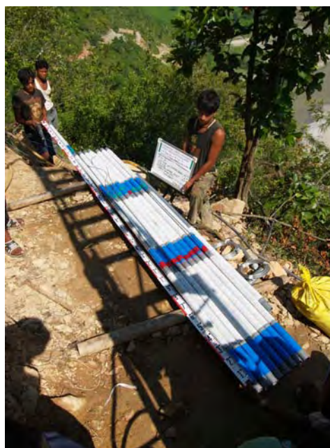
写真 8-7-4 BV-2. 歪計検尺
