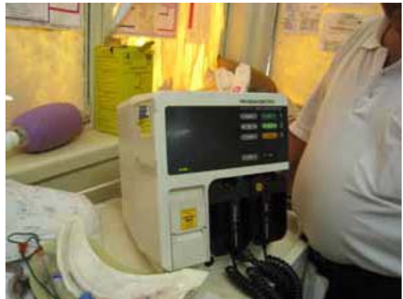
救急外来 除細動器 心電モニタ機能は故障
