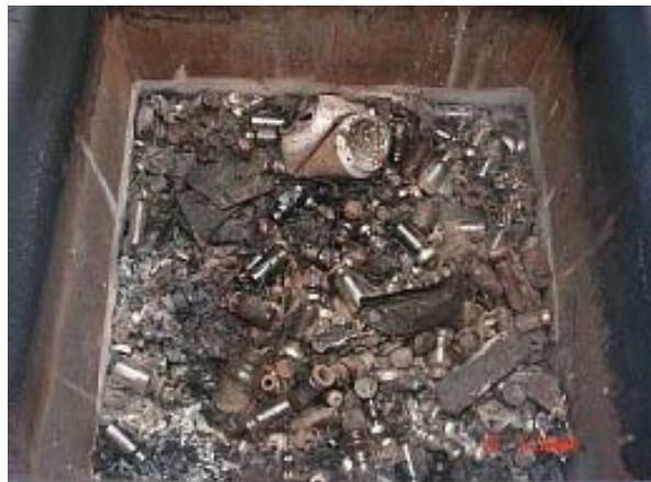
左の装置を運転した結果。熱風滅菌するが結果的には高温すぎて焼却している事になり医療廃棄物のプラスチック製品からダイオキシンの発生が危惧されている
