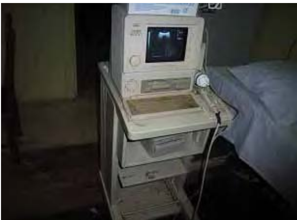
写真-11：放射線室 超音波診断装置： プローブが消耗しており、コンソールも傷みが 激しく、適切な診断ができない。
