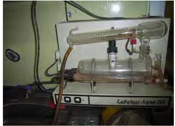
写真-8：検査室 自動蒸留水製造機： 調達後 15 年程度経過。老朽化が著しく、 故障が頻発する。
