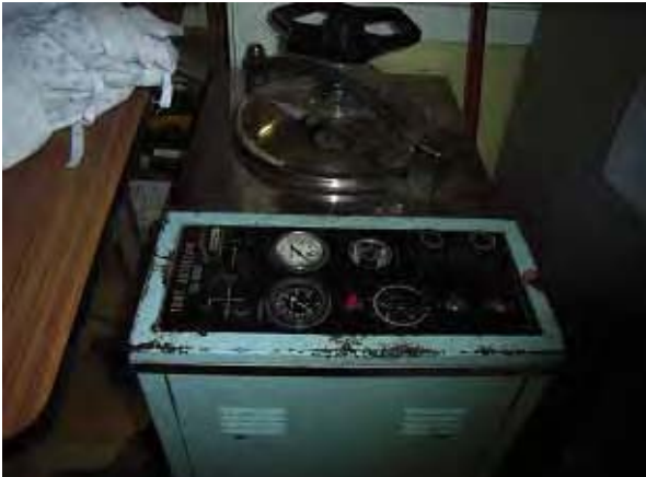
写真-9：検査室 高圧蒸気滅菌器： 20 年前に製造された型式であり、頻繁に 故障する。
