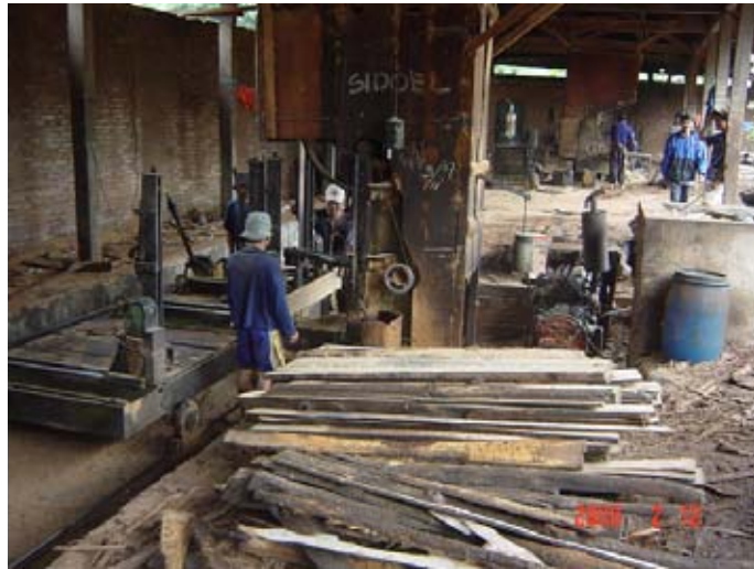
Photo. 2-13 送材車付き帯のご盤による製材作業
