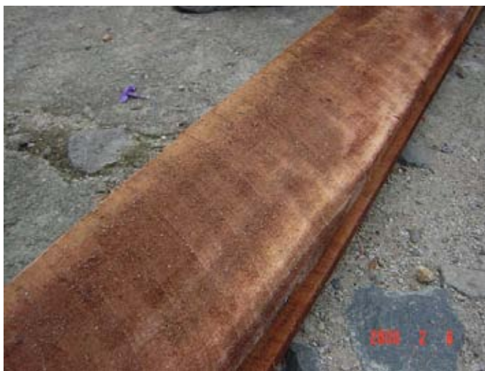
Photo. 2-8 チェーンソーで製材された板（弧状の切削跡が見える）
