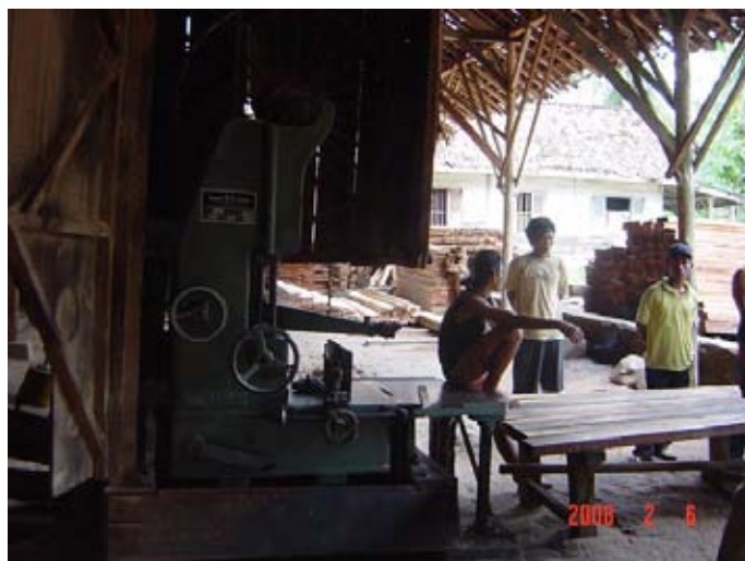
Photo. 2-10 ランプンの製材所のテーブル帯のこ盤
