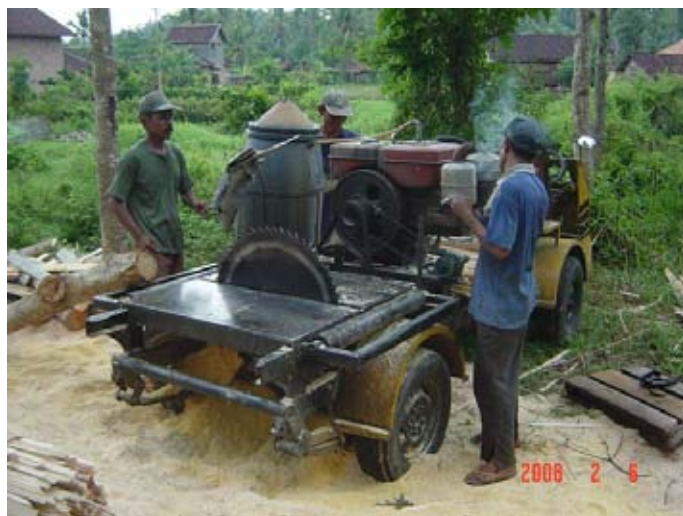
Photo. 2-9 車に積載された移動式の丸のこ盤
