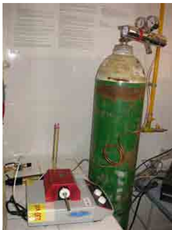
図 3.3-33 検量線作成用インジェクションシステム(左)及び TECORA ポンプ(右)
