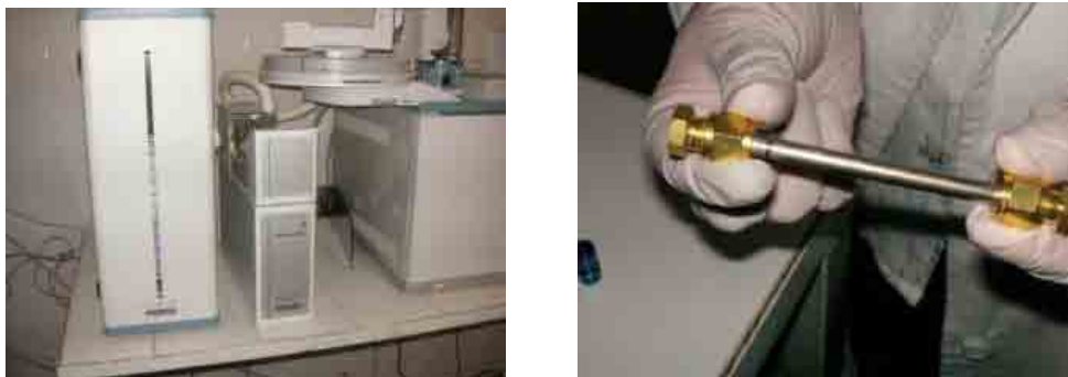
図 3.3-36 GC 試料導入装置と加熱脱着機器(左)加熱脱着用チューブと長期保存用キャップ(右)
