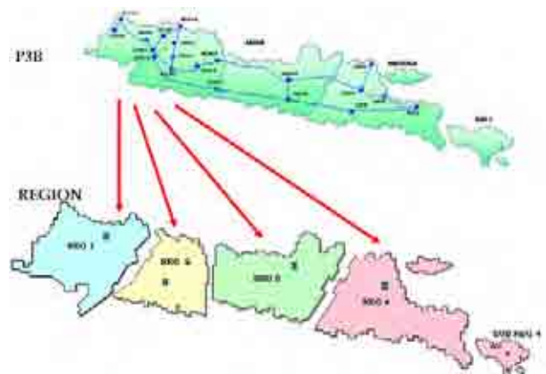
図 2.4-6 ジャマリ系統の制御地域区分
