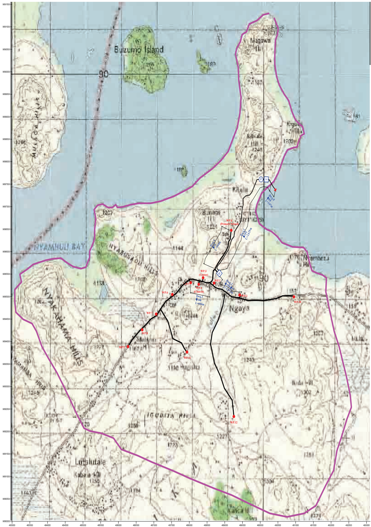
図 3.1 1 : NGAYA 共同水栓スキーム (浄化施設を設け湖水利用)
