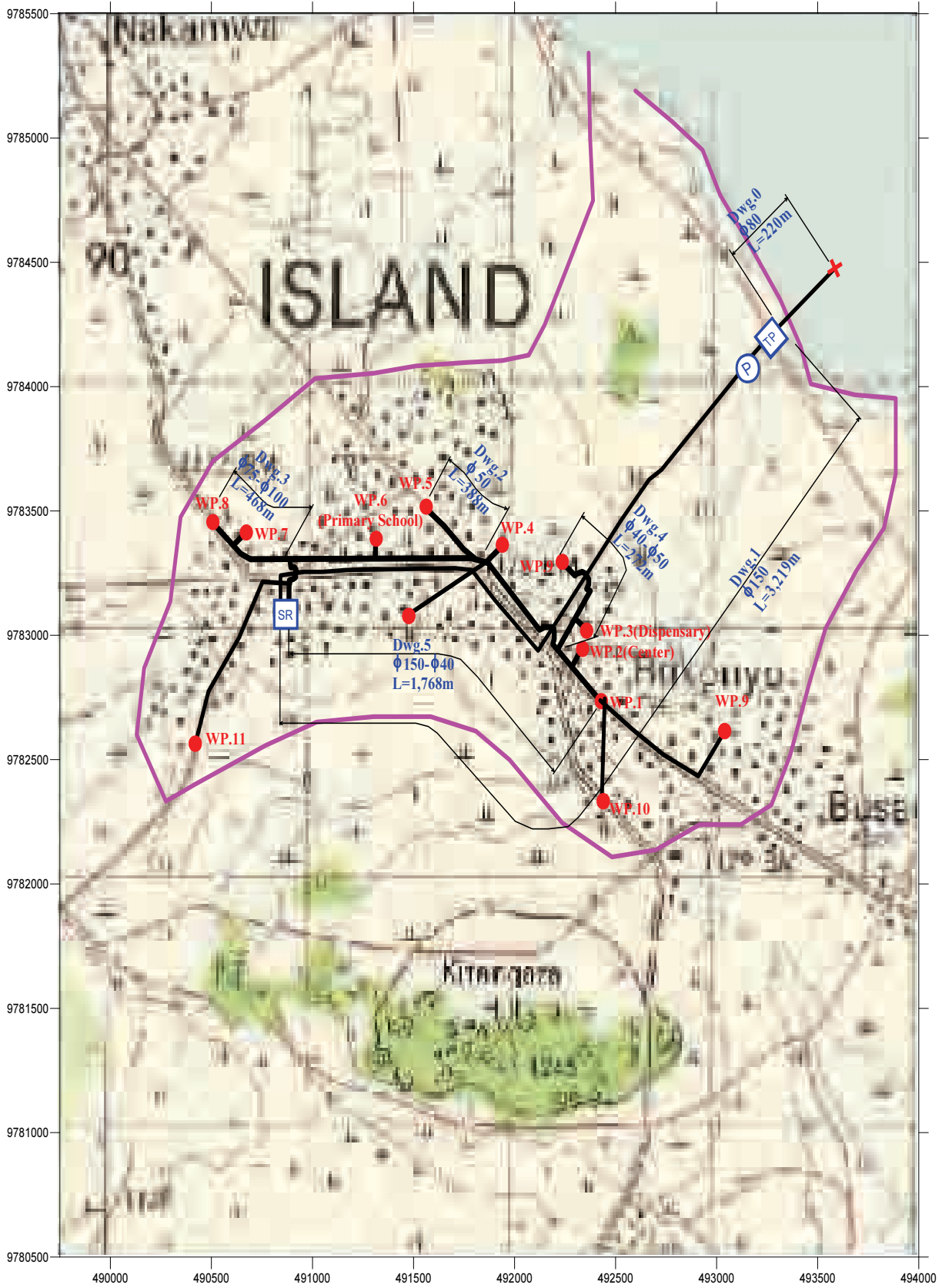
図 3.10 : BUKONYO 共同水栓スキーム (浄化施設を設け湖水利用)
