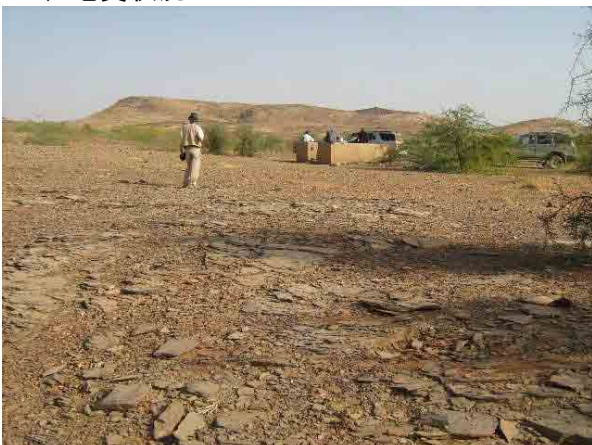
写真-17 ほぼ水平な片離構造を持つ片岩が地表に露出、風化は進んでおり、地下水開発が可能
