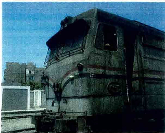
ABB社1992年製ディーゼル機関車、連結器は自動連結器
