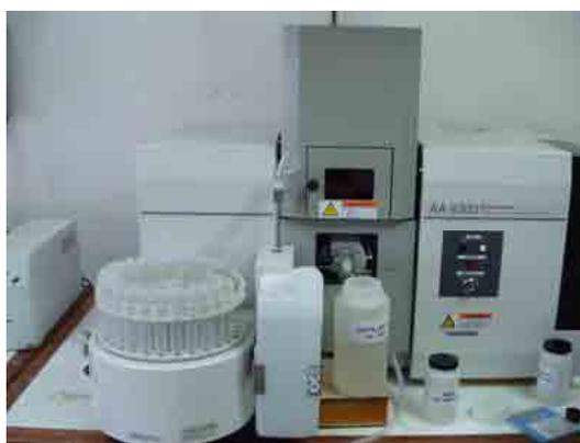
写真 6.2.4 AAS-Shimadzu6300 (フレーム式)
