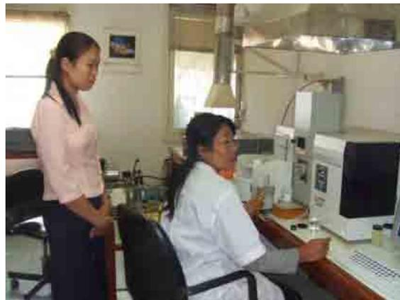
写真 6.4.2 AAS-Shimadzu6300 による金の分析
