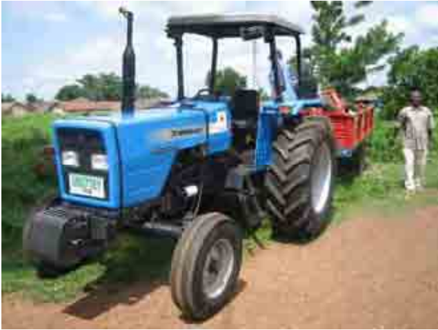
写真7: 2005年度2KRで調達した乗用トラクター(イタリア製) 北部州サベルグナントン県ナボコ村にて写す。農民70名でお金を出し合って購入した。1日3~4ha(6~7時間)の耕起作業が可能であり、4月末に購入してからすでに600時間使用している。
