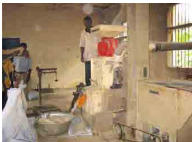
写真6: アヌン谷灌漑プロジェクトで使用している初搾り精米機(日本製) 1999年度2KRで調達した機械であり、現在も稼働中。精米が美しいと評判である。
