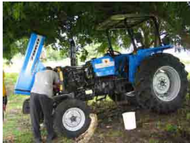
写真14: Kartey Farmの乗用トラクターの整備を行っているところ ディーゼル燃料ポンプの交換をしている。
