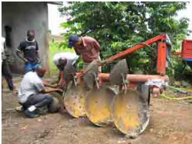
写真13: グレートアクラ州西ダングメ県アスツレ・ジャンクションのKatery Farm 2005年度2KRで乗用トラクター(イタリア製)と作業機(イタリア製)を購入した。土壌が固いことから4連のディスクプラウが引けず、3連にして使用している。
