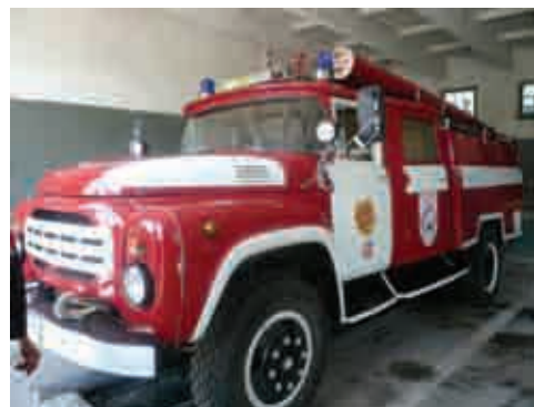
各署配備の2,400lit.水槽付消防車 出動前にエアブレーキ空気充填に2~8分要し、出動途上の故障も有り
