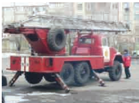
はしご車は、梯体摺動部分、伸張のためのワイヤーロープ等が磨耗し、危険な状態で使用
