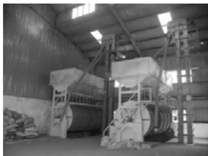
コーヒー豆の回転式乾燥機 （ソラ省経営の加工工場）
