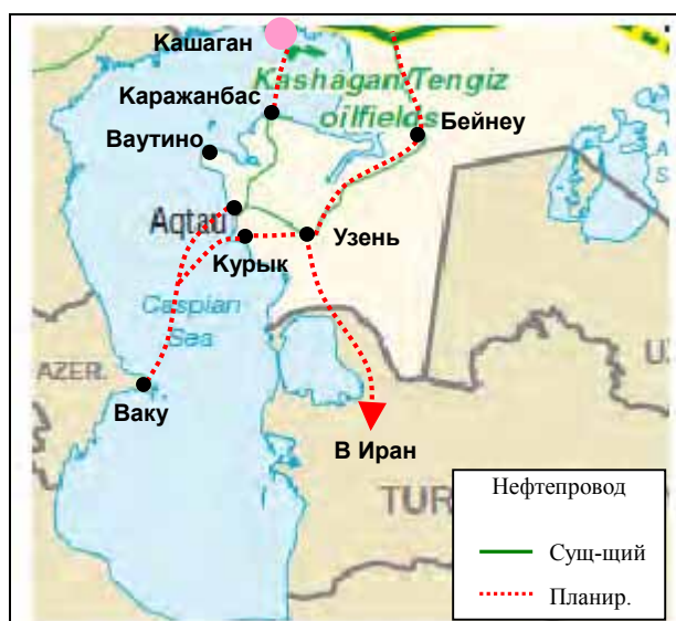
Рисунок 5.2 Существующий и планируемый нефтепровод
