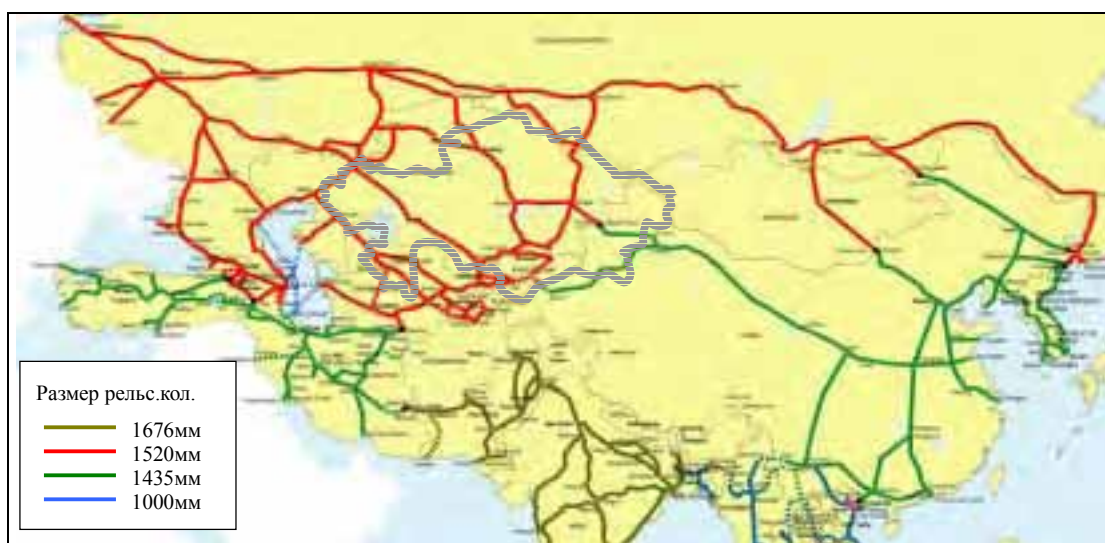
Рисунок 7.4 Система ширины рельсовой колеи в странах СНГ
