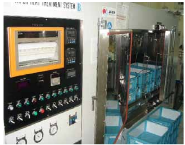
写真4：プロジェクト供与機材（蒸熱処理機）
