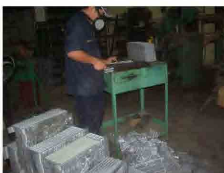
Figura 5.6 Haciendo placas de plomo para batería reciclada
