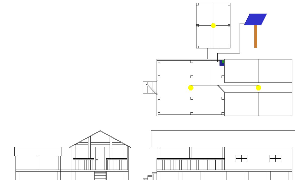
Gráfico III-2.5-3 Ejemplo de Vivienda y Cableado (Tarapoto)
