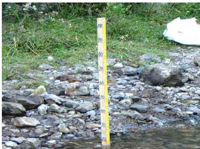
Fotografía III-3.5.1-9 Limnómetro Instalado (ST.1)
