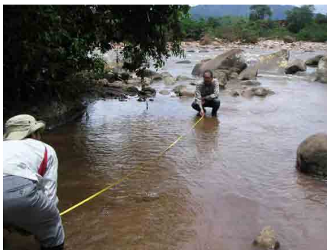
Fotografía III-4.5.1-8 Aforo de la Descarga del Río
