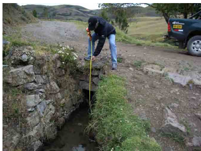
Fotografía III-3.5.1-11 Aforo de la Descarga en el Canal de Irrigación
