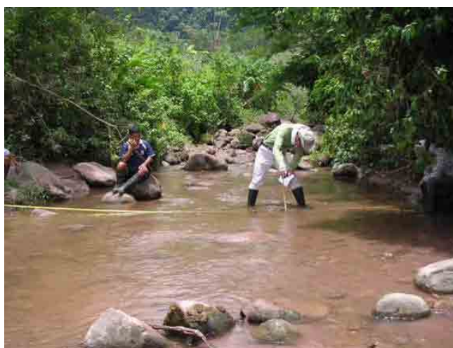
Fotografía III-4.5.1-7 Aforo de la Descarga del Río
