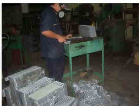
Figura 5.6 Haciendo placas de plomo para batería reciclada
