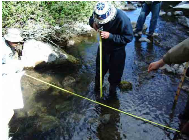
Photo III-3.5.1-10 河川断面測定状況
