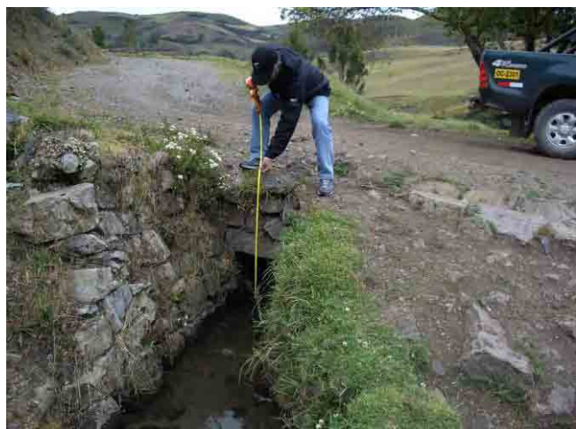
Photo III-3.5.1-11 灌漑用水路流量測定
