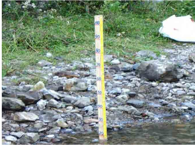
Photo III-3.5.1-9 量水標設置後 (ST.1)
