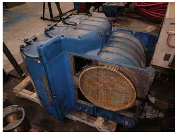
開放後、清掃が行われる潤滑油冷却器
