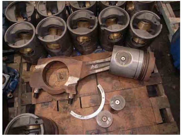
取外し清掃が行われているピストン
