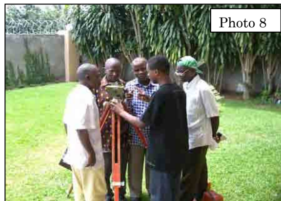
Placement d'un point de repère national (P/014) au moyen d'une GPS portative
